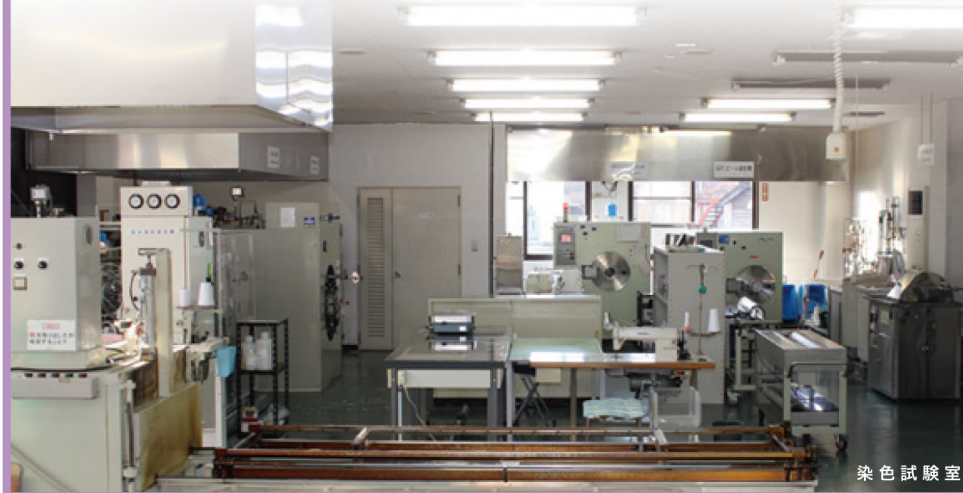
小型連続ヒートセッター ・セット温度 230℃まで可能 ・生地幅 50 ~ 200cm ・長い生地のセットが可能 ・オーバーフィード装置付き ・自動追従装置付きで、結反した生地の連続セットが可能
