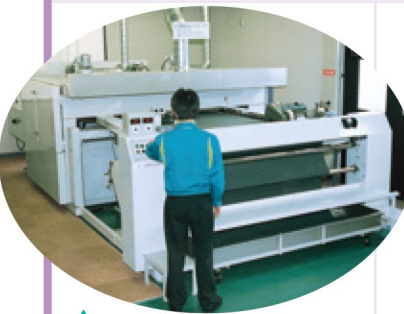
小型連続ヒートセッター ・セット温度 230℃まで可能 ・生地幅 50 ~ 200cm ・長い生地のセットが可能 ・オーバーフィード装置付き ・自動追従装置付きで、結反した生地の連続セットが可能
